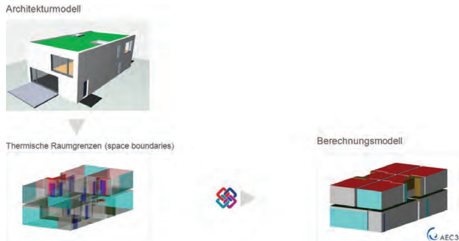
Abbildung 4.20: Übergabe des Modells zur thermischen Berechnung (Quelle: AEC3)
